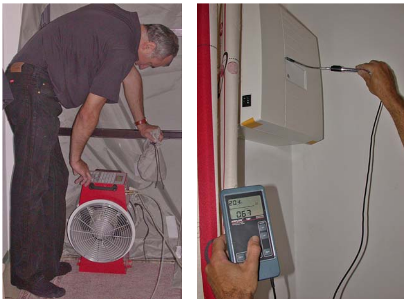
Figur 3.17 and 3.18 Kontroll av lufttätthet i en vägg under byggskedet (till vänster). Luftläckage spåras till exempel med rök och mätningar med luftpåströmmingsmätare (höger)
